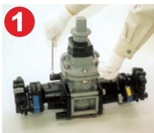
接続用六角ボルト、袋ナット(4組)を取り外し、仕切弁部と継手部を分離する。
