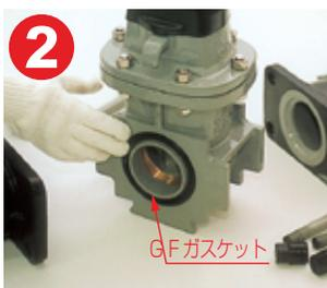
仕切弁部の接続フランジに、GFガスケットが、確実に収まっていることを確認して下さい。
