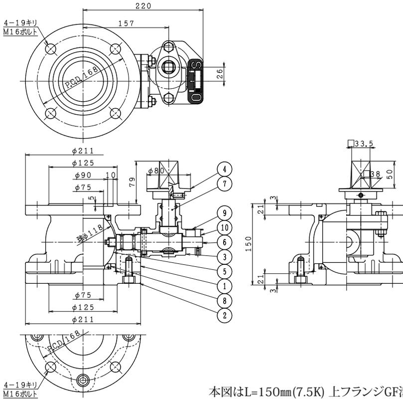
本図はL=150mm(7.5K) 上フランジGF溝付の場合を示します。
