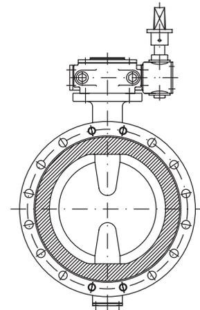
弁箱はFC製 / 弁体はFCD製かステンレス製をお選びください。
