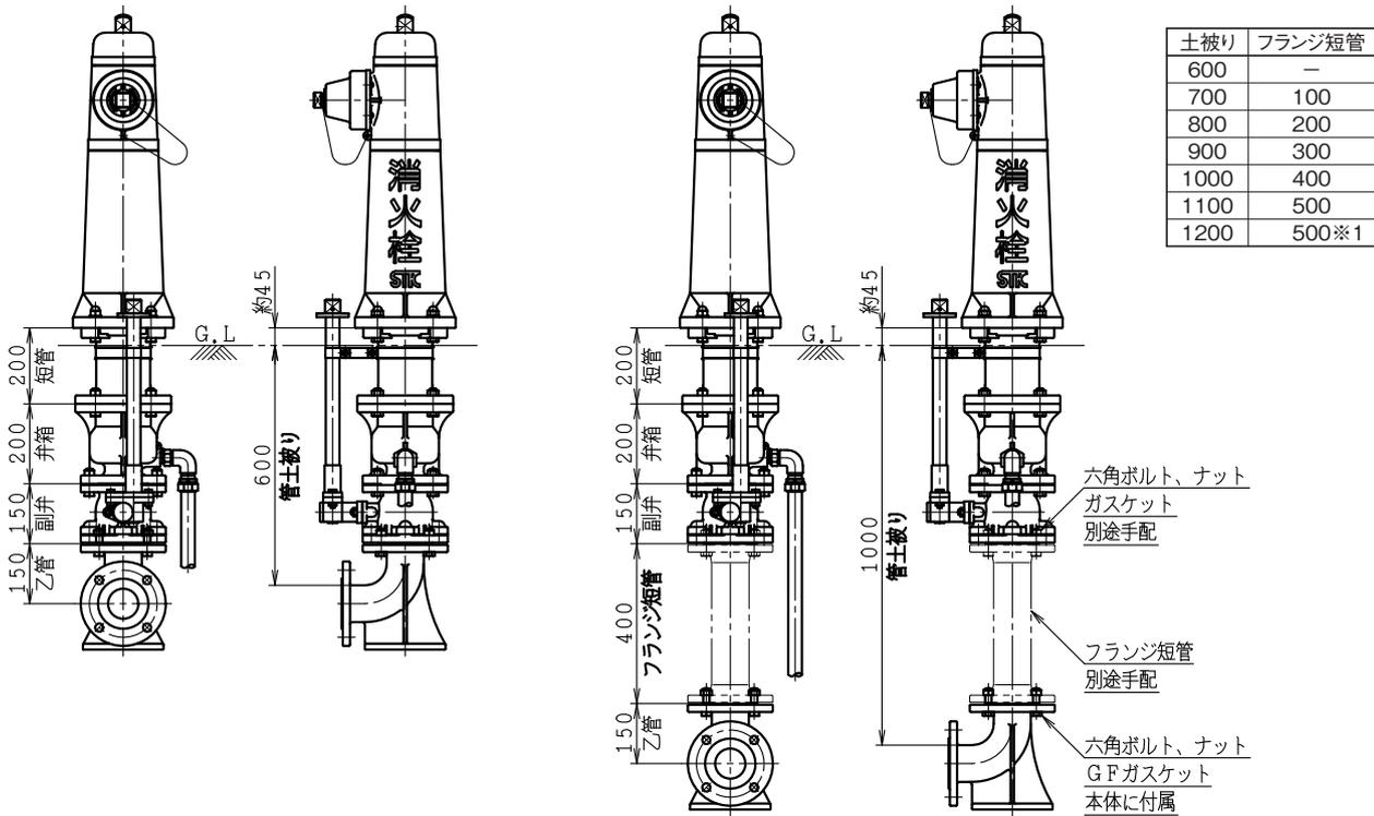
φ75単口 口金回転式打倒型 (UR-371) 地上式消火栓
