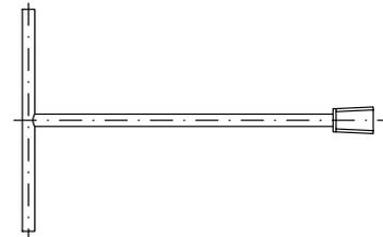
材質SS(標準軸径φ25)又はSGP(標準軸径φ34)製
