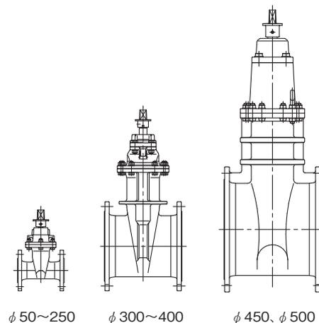
FCD製／内外面粉体塗装／ボルトSUS 304製／止水部はゴムシート
