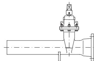
FCD製／内外面粉体塗装／ボルトSUS 304製／止水部はゴムシート
