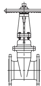
FCD製／内外面粉体塗装／ボルトSUS 304製／止水部はゴムシート
